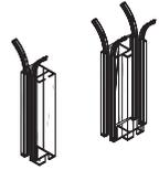
**Generell:** Vor der Montage der Führungsschienen müssen die oben herausstehenden Keder bündig mit Oberkante Führungsprofil abgeschnitten werden. Die Anzahl der Abstandhalter je Führungsschiene ist aus den Tabellen zu entnehmen.
