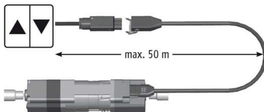
6. **Der J4 WT kann parallel geschaltet werden (Empfehlung bis max. 3 Antriebe). Dabei sind die ist Angaben (z.B. max. Schaltbelastbarkeit, max. Anzahl der Antriebe pro Motorausgang) des entsprechenden Schalter- / Steuergerät- bzw. Aktorherstellers zu beachten. (Anlaufstrom J4WT: 9A in den ersten 3ms). Maximale Gesamtleitungslänge: 50 m. Bitte beachten Sie auch Punkt 12.**
