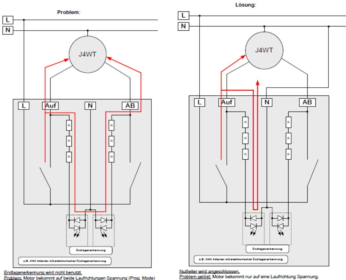
Dabei dient der Neutraleiteranschluss am Aktor als notwendiger Messpunkt. In diesem Fall muss zwingend jede N-Klemme (Messpunkt am Aktor) und jeder Antriebsneutraleiter auf Neutraleiterpotential (N-Schiene) gelegt werden.
