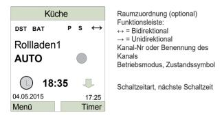
Durch Drücken der Menütaste "**Timer**" kann die Aktivierung der automatischen Zeitschaltfunktion für den Kanal ein- oder ausgeschaltet werden.
